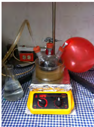
Figura 3.9: Disolución bajo una atmósfera inerte y a una temperatura de 80\text{ }^{\circ}\text{C} .
