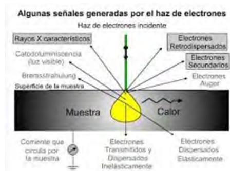
Figura A.6: Diagrama que representa las diversas señales que se generan con la interacción del haz de electrones sobre la muestra y las regiones en las cuales se detectan estas señales.
