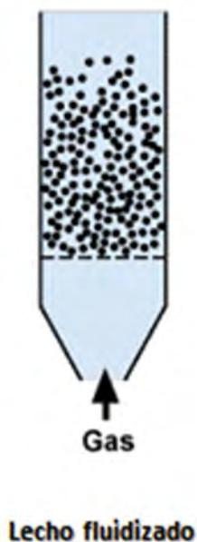
**Figura 8.** Esquema general de un reactor de lecho fluidizado.<sup>29</sup>
