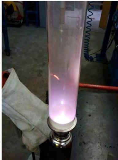
**Figura 12.** *Funcionamiento del reactor plasma-lecho fluidizado.*
