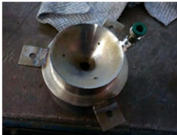
**Figura 10.** Alimentador de gases. Cuenta con tres orificios en forma angular con la finalidad de generar un vórtice.
