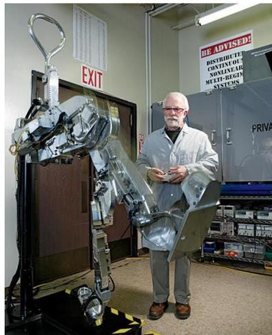
Figura 1.4. Pruebas preliminares del exoesqueleto XOS (Dollar & Herr, 2008)
