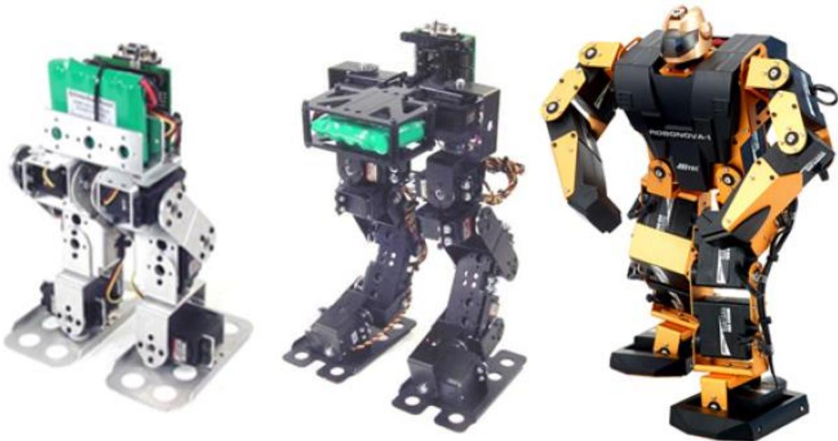
Figura 1.6. Robots bípedos comerciales, BRAT (6 GDL), Scout (12 GDL) y Robonova.
