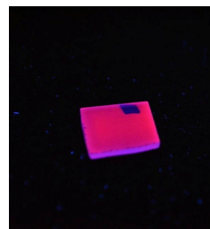
Figura 3.19: Fotografía de una película de \text{Al}_2\text{O}_3 : \text{Eu}^{3+} después de ser excitada con una lámpara UV, con \lambda = 254\text{nm} .
