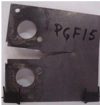
Figura 4.5. Apariencia de la probeta luego del ensayo de fatiga.
