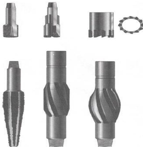
Figura 2.24. Zapatas dentadas y molinos para cortar y moler
