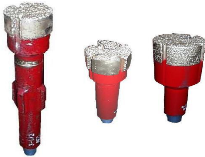
Figura 2.25. Molinos con diferentes configuraciones de fondo
