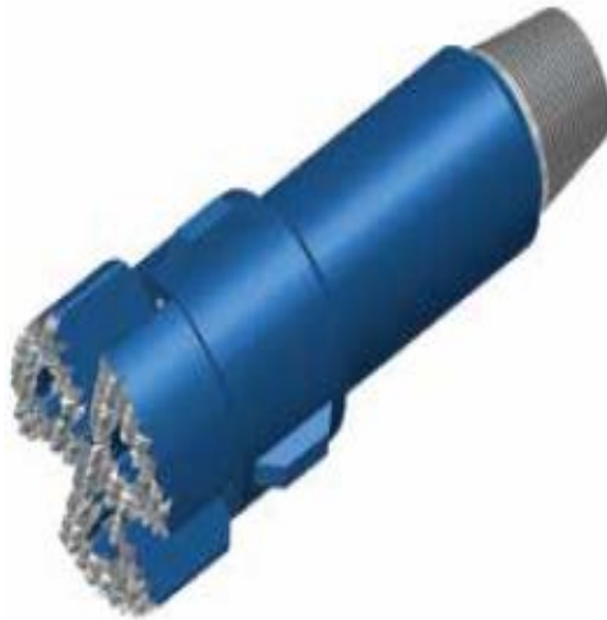
Figura 2.4. Fresa de detritos. Una leve concavidad en la cara de la fresa ayuda a centrar los detritos por debajo de la superficie de corte para triturarlos en trozos más pequeños.
