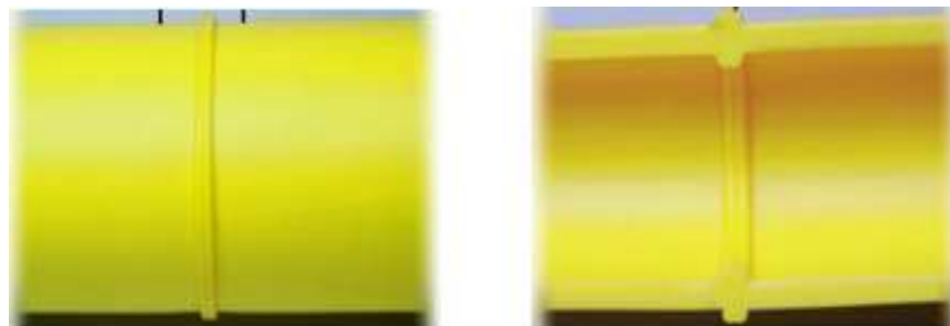
Figura 1. 8 Soldadura a tope [36 ]
