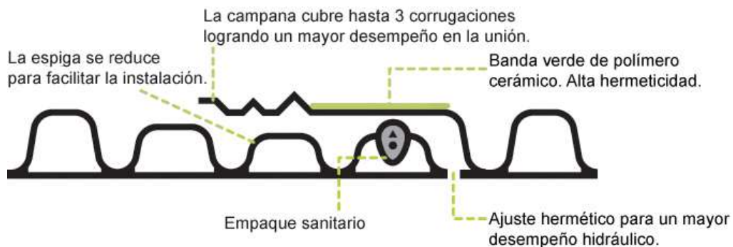
Figura 2.3 Región donde se aprecia que la altura de las últimas tres corrugaciones de la espiga es menor que las del resto del tubo [12]
