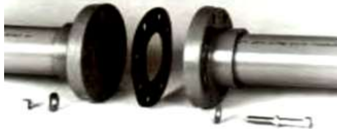
Figura 1. 16 Unión por medio de brida [35]
