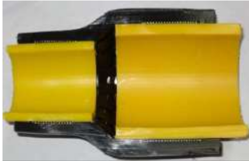
Figura 1. 11 Soldadura por electrofusión [36]
