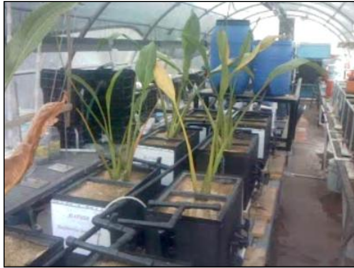
Figura 11. Reactores conectados a los tanques de alimentación.
