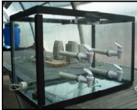
Figura 10. Estructura del HAFSSR con tubería interna y puntos de muestreo en costado
