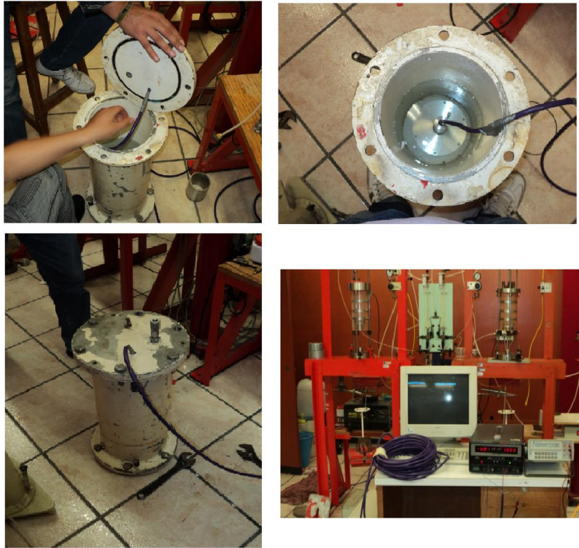
Figura 39. Calibración celdas de presión tipo Jack-Out
