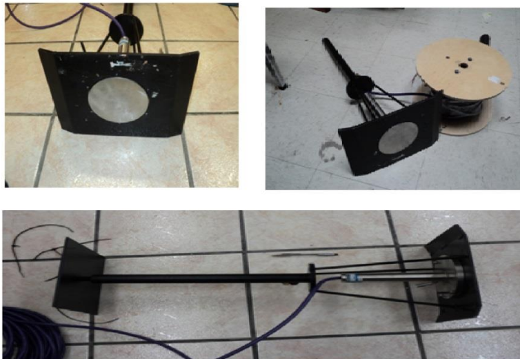
Figura 35. Celdas de presión tipo Jack Out
