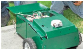
Fig. 2.3 Sistema mecatrónico de detección de fuego
