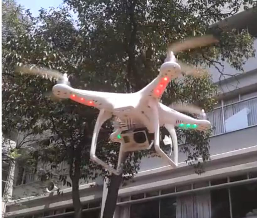
Fig. 3.21 DJI Phantom con cámara montada en funcionamiento
