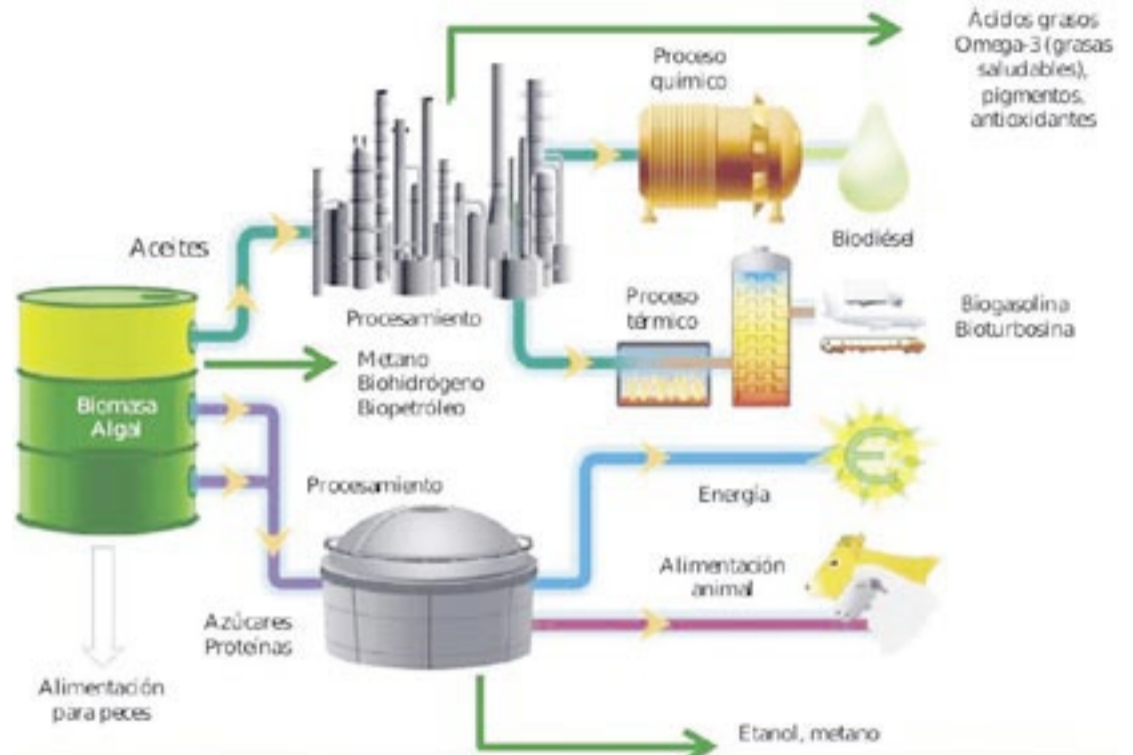
2. Esquema general de procesos para la producción de biocombustibles, ácidos grasos, pigmentos y alimentos para ganado a partir de cultivos microalgales, entre otros. Al concepto de generar varios productos a partir de material biológico, similares a los obtenidos a partir del petróleo en una refinería, se le conoce con el nombre de 'Biorefinería' (Adaptado de Olivares, 2011).
