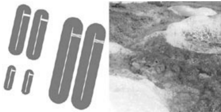
Sistema abierto al ambiente para el cultivo de microalgas y macroalgas en estanques tipo "pista de carreras".
