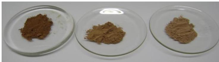
Figura 3.22. Pigmentos obtenidos por el método de reacción en estado sólido;  $\text{Al}_{1.91}\text{Mn}_{0.09}\text{O}_3$ ,  $\text{Al}_{1.95}\text{Mn}_{0.05}\text{O}_3$  y  $\text{Al}_{1.97}\text{Mn}_{0.03}\text{O}_3$ .
