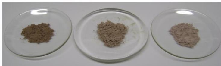
Figura 3.21. Pigmentos obtenidos por el método de co-precipitación y posterior tratamiento térmico;  $\text{Al}_{1.91}\text{Mn}_{0.09}\text{O}_3$ ,  $\text{Al}_{1.95}\text{Mn}_{0.05}\text{O}_3$  y  $\text{Al}_{1.97}\text{Mn}_{0.03}\text{O}_3$ .
