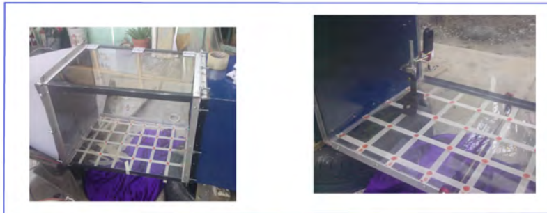
FIGURA 4.1.1. Medición de la velocidad en distintos puntos de la zona de prueba utilizando el anemómetro de veleta.
