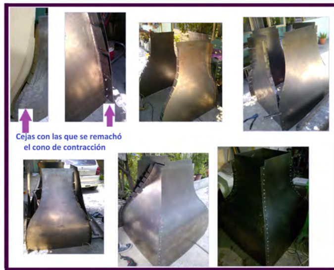
FIGURA 3.2.2. Se muestran tanto las “cejas” dobladas al borde de la lámina para poder remacharla, como el ensamblaje de la misma para formar el cono de contracción. Este primer ensamblaje efectivamente se realizó poco a poco por medio de remaches como se muestra en las fotografías.
