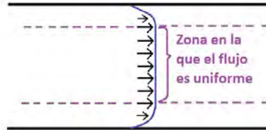
FIGURA 1.1.3. Perfil de velocidades esperado en la zona de prueba. Se observa que la velocidad es uniforme en una sección central amplia.
