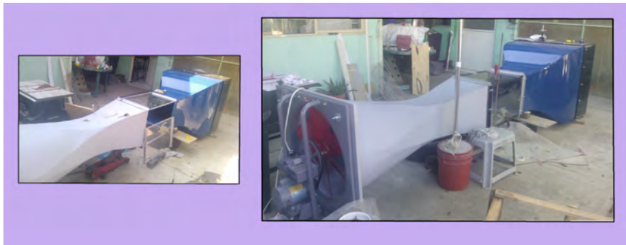
FIGURA 3.5.1. Se observa al lado izquierdo la ejecución de los últimos detalles del túnel de viento, que consistieron en montar la zona de prueba. Al lado derecho se muestra el túnel de viento ya listo para usarse; la prensa observada en la zona de prueba corresponde al mecanismo inmediato mediante el cual se puede cerrar herméticamente esta sección. Posteriormente puede diseñarse otro mecanismo que no involucre la utilización de la prensa.
