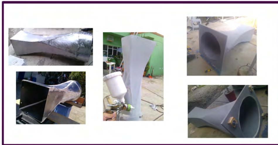
FIGURA 3.3.2. Imagen en la que se observa el lijado del difusor, aplicación de pasta, “primer” y ensamblaje del mismo con la base de madera circular.
