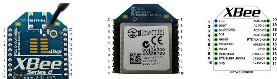
Figura 17: Dispositivos Xbee utilizados.
