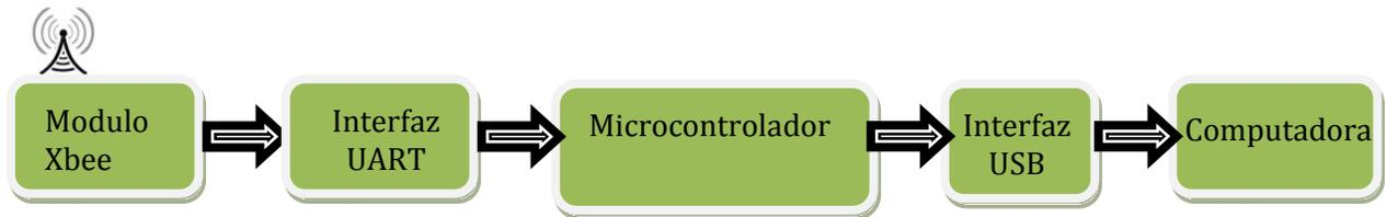
Figura 36: Diagrama general de hardware del coordinador.
