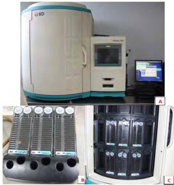
Figura 12 Método automatizado para identificación de bacterias A. Incubadora Phoenix 10 TM B. Galerías para determinar asimilación de carbohidratos C. Incubación de las galerías a 37°C
