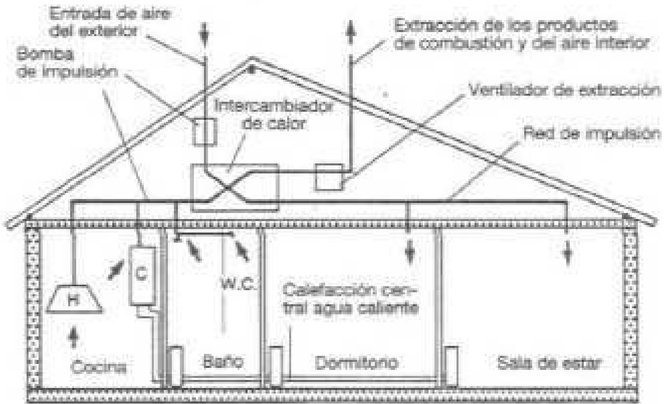
Instalación con doble flujo de aire para ventilación natural (El arte de proyectar en Arquitectura, Neufert Ernest, 1995, Página 106)
