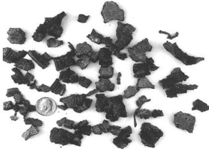
Figura 5. Daño producido a una tubería (10 pulgadas de largo por 1.5 de diámetro) por un explosivo de alta potencia (RDX: militar C-4).
