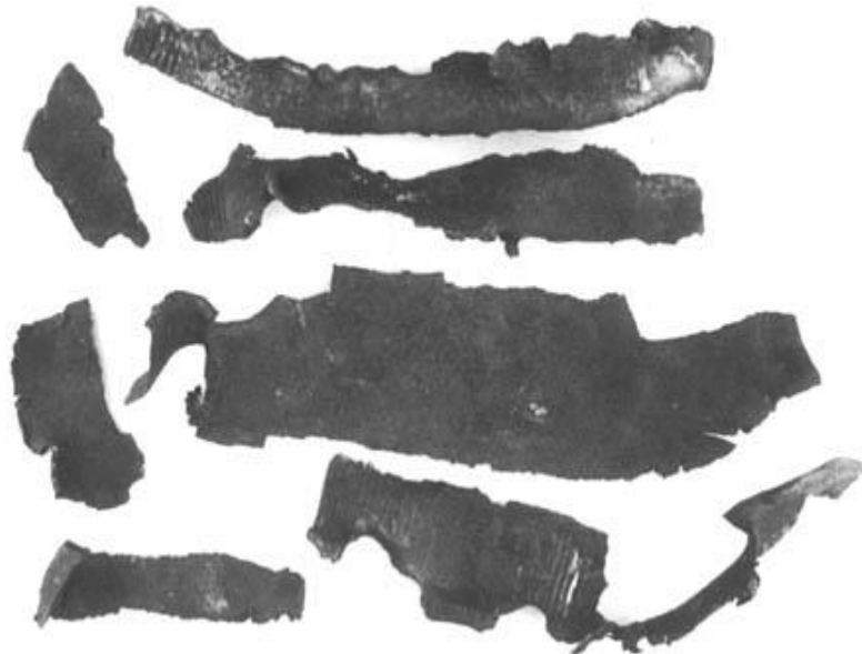
Figura 4. Daño producido a una tubería (10 pulgadas de largo por 1.5 de diámetro) causado por pólvora sin humo de doble base, iniciada por una capa detonante.
