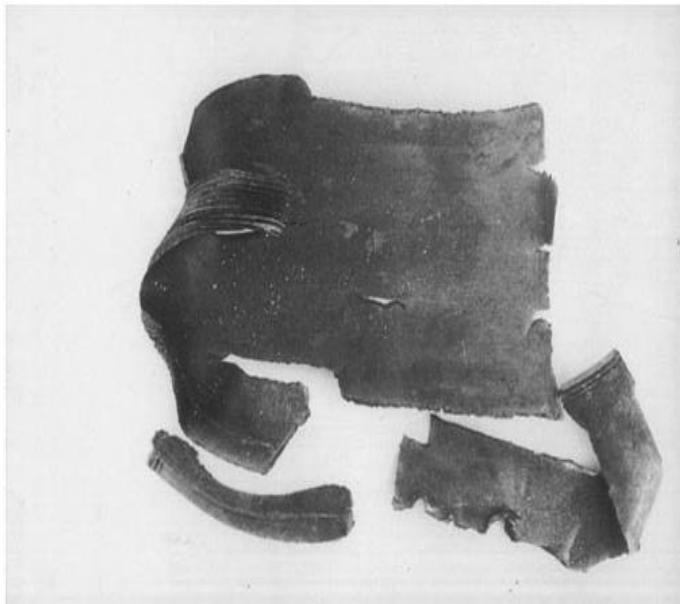
Figura 2. Daño producido a una tubería (10 pulgadas de largo por 1.5 de diámetro) causado por pólvora sin humo de una base, iniciada una capa detonante.
