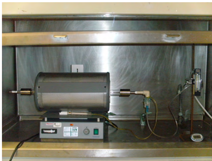
Figura 2.1. Arreglo experimental para la síntesis de nanotubos de carbono multipared por rocío pirolítico.
