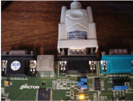
Imagen 6.10 Cable RS-232 a USB. Comunicación Starter Kit con computador portátil. [Fotografía tomada]
