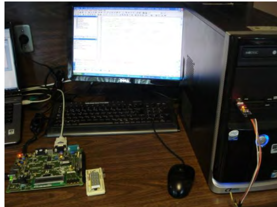
Imagen 6.14 Spartan-3E Starter Kit. [Fotografía tomada]
