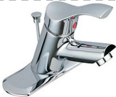
Mezcladora mono mando para lavabo. Instalación en 3 orificios a 4". Incluye desagüe. Acabado Cromo. Presión de agua requerida: estándar. Ahorradora de agua. Flujo normal 2.06 por minuto. Máximo 5.6 L por minuto.
