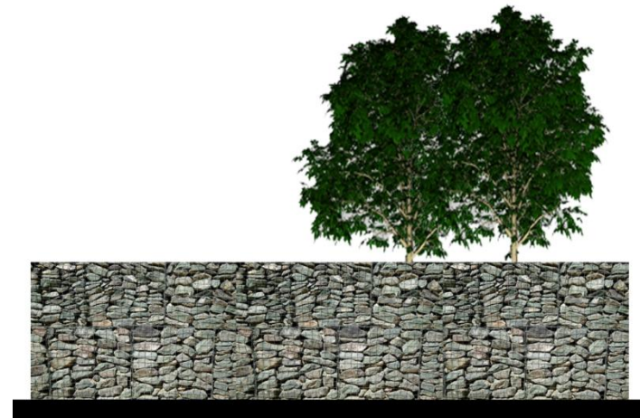
Muro con piedra contenido con malla ciclónica
