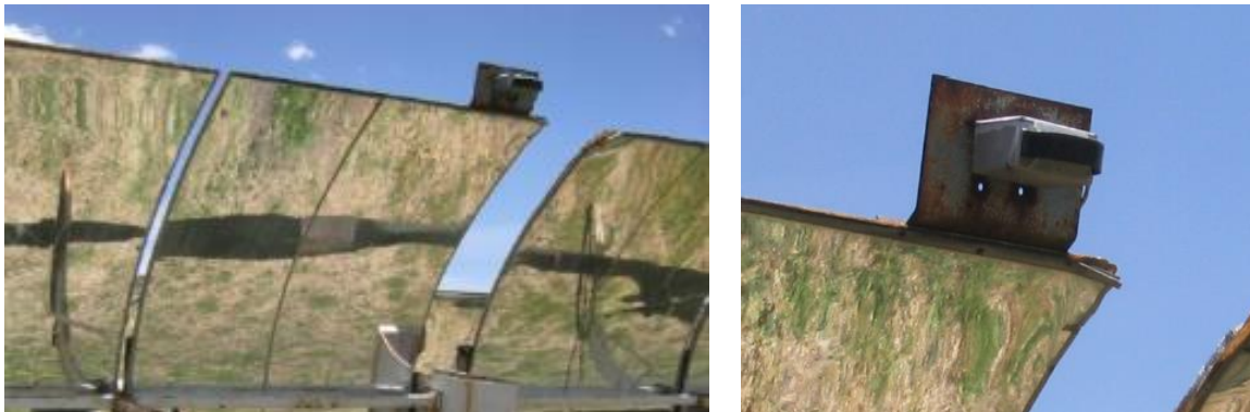
Figura 18. Sistema de seguimiento solar.
