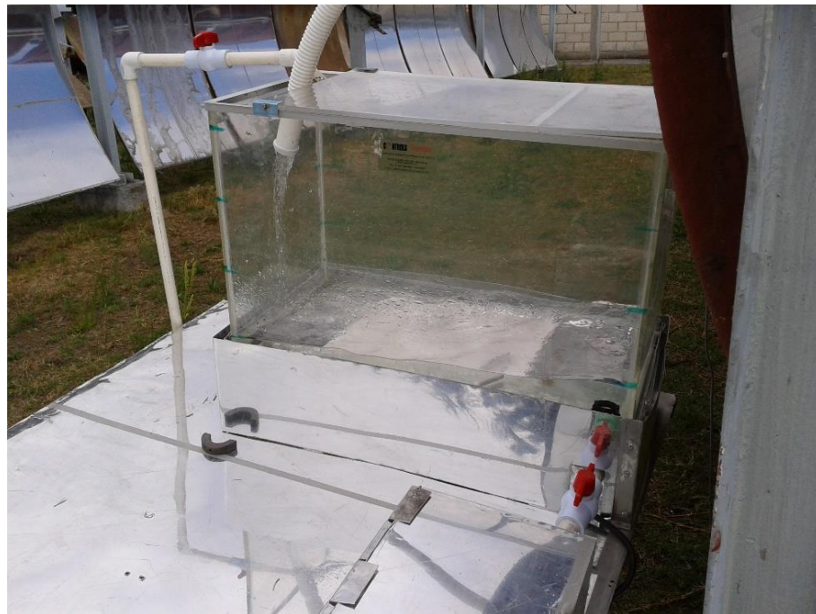
Figura 67. Contenedor del sistema de reacción del CCP.
