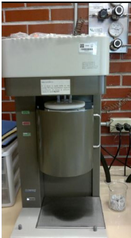
Figura 6.12: Equipo Bel Japan Minisorp II usado para medir área superficial por adsorción de nitrógeno
