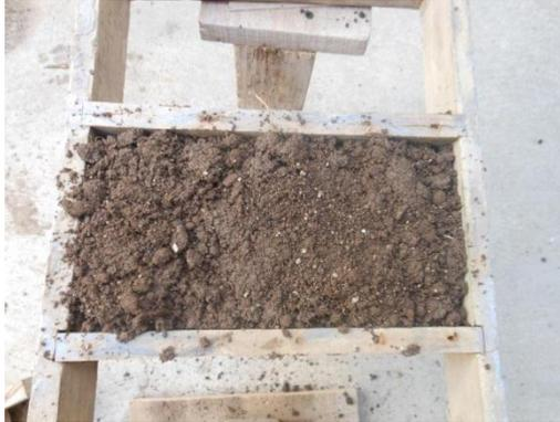
**Figura 92.- Arcilla mezclada con agua en una proporción del 30% de humedad.**
