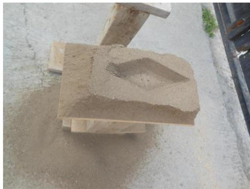
**Figura 88.-** Resultado de la primera iteración, de moldeo.
