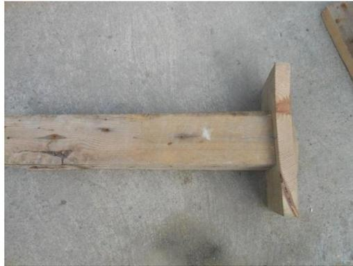
**Figura 82.- Apisonador de madera fabricado para la pruebas.**
