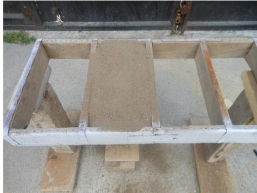
**Figura 85.-** Rejilla de moldeo apoyado en soportes.
