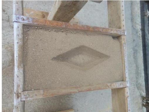
**Figura 87.-** Rejilla de moldeo una vez que se comprimió la arcilla con el apisonador.
