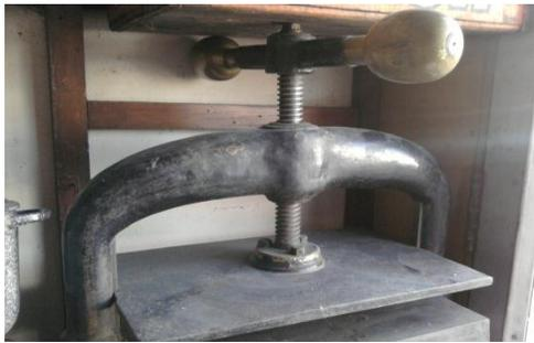
Figura 30.- Prensa manual, principio de banco vertical. (Google Imágenes)
