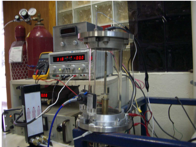
Figura 2.3: La imagen muestra la foto de la cámara donde se puede observar los atravesadores eléctricos en los que están colocados los electrodos.
