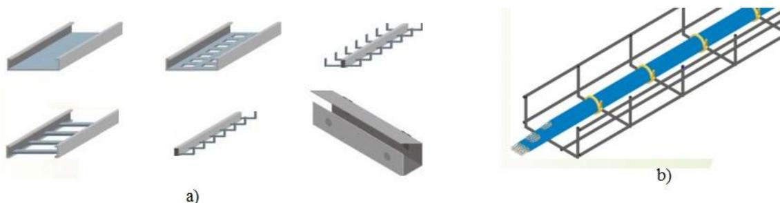
**Figura 2.10.** a) Tipos de escalerilla, b) Cableado en escalerilla.
