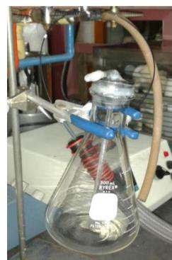
Figura 3.11 Fotografía del arreglo de almacenamiento de biogás para su análisis
