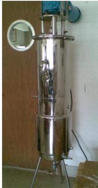
Figura 3.3 Fotografía del fermentador oscuro en experimentación
