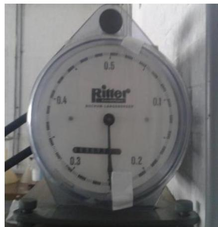
Figura 3.9 Medidor de flujo de biogás
