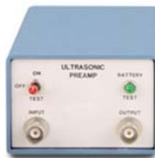
Figura 3.3: Amplificador Panametrics® 5676 compatible con el Handy Scope HS3®
