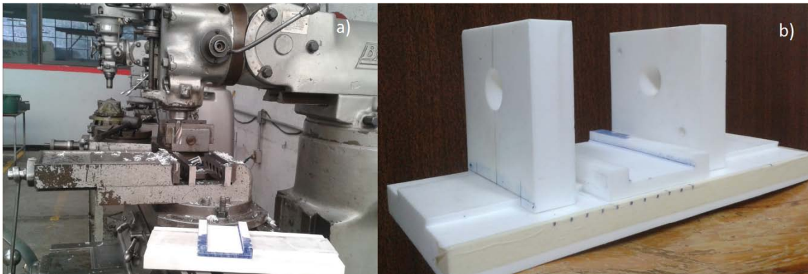
Figura 3.7: En (a) el equipo empleado para la fabricación de la base, en (b) la base terminada.
