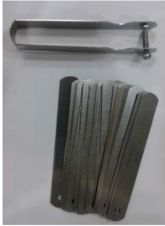
Figura 3.12: Calibradores para el ancho de las fracturas
