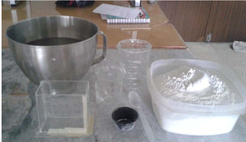
Figura 3.10: Elaboración de la pasta de cemento
