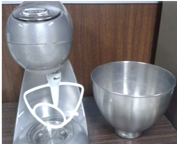
Figura 3.8: Batidora de acuerdo con la Norma (ASTM) C 305-99)
