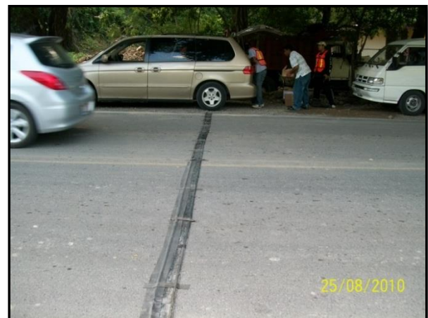
Figura 42 Imágenes de los contadores automáticos en carretera.
