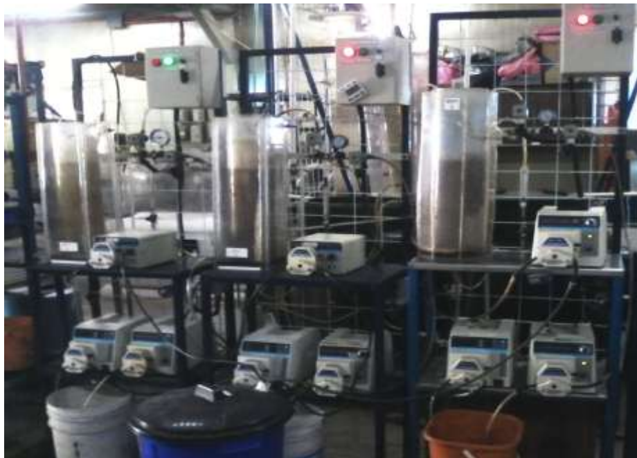
Figura 3.2 Sistemas experimentales: a) Diagrama de los tres BRM, b) Fotografía de los tres BRM.
