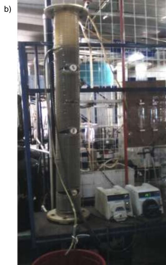
Figura 3.1 Sistemas experimentales: a) Diagrama experimental del reactor UASB, b) Fotografía del reactor UASB.
