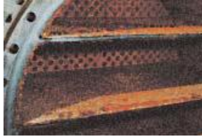
Fig. 2.5 Corrosión en sistemas de enfriamiento
