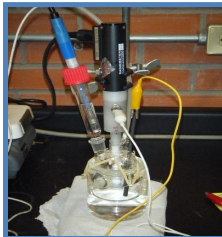
Fig. 3.5.- Sistema montado con los electrodos en nuestra celda electroquímica.
