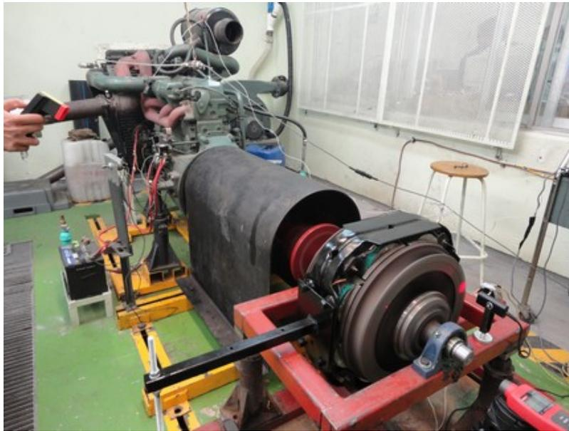
**Foto 21. Dinamómetro de banco y motor diésel.**
