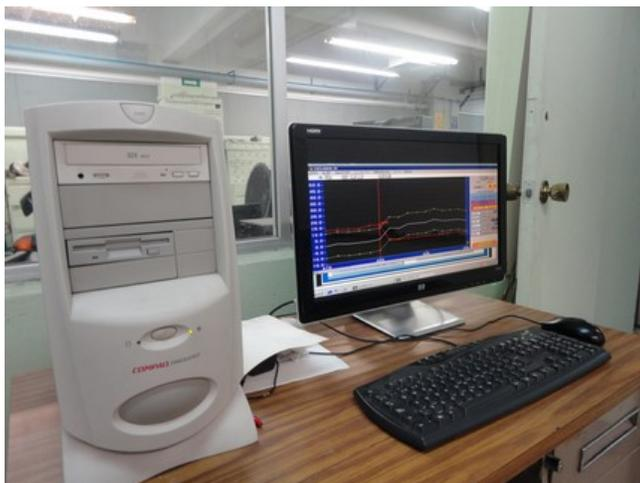
**Foto 25. Equipo de computo para el control del dinamómetro de chasis.**
