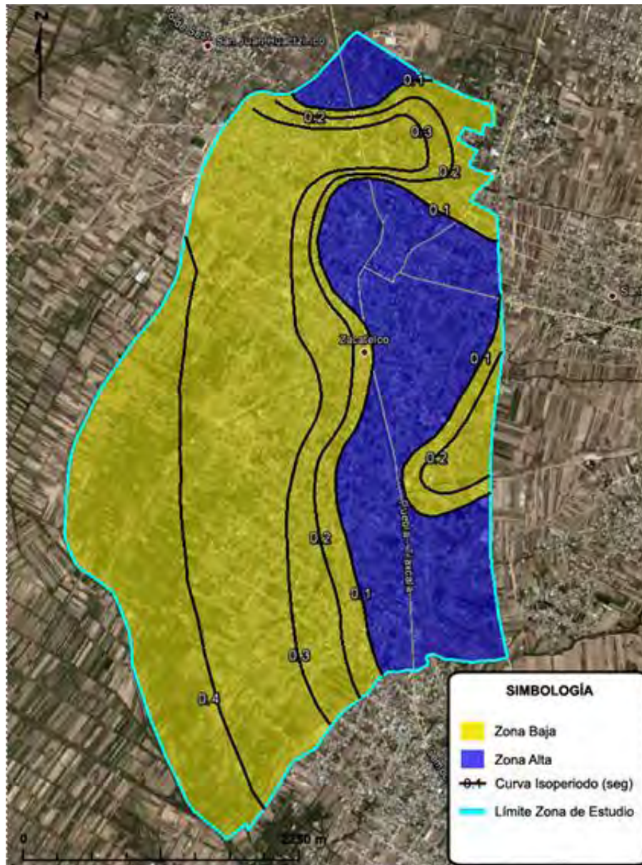
Figura 2.14 Mapa de Isoperiodos y Microzonificación propuesto para el municipio de Zacatelco, de color amarillo corresponde a la zona de depósitos aluviales y la zona de color azul indica la zona de lomas.
