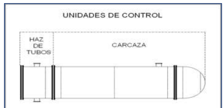
Figura 2.15 Unidad de Control en un Intercambiador de Calor
