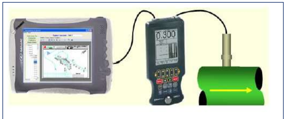
Figura 2.19 Equipo DMS-2 para la medición de espesores en las tuberías
