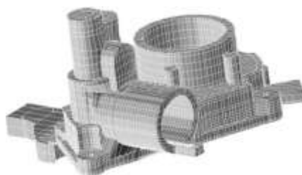
Imagen 2.1 Modelo tridimensional de una pieza plástica de un motor diesel fabricado en un Suzuki Santana motor, S.A. creado en A-Mesh® (López, 2011)
