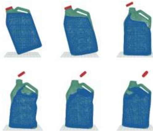
Imagen 2.15 Visualización de resultados con incrementos de 0.01 [s] iniciando en el instante cero (Simulia, 2.3.2, 2012).
