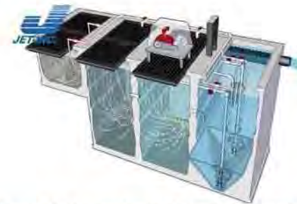
Gráfico 193. Planta de tratamiento de celdas prefabricadas.
