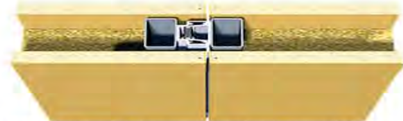
Gráfico 189. Muro móvil con propiedades acústicas para las aulas.
