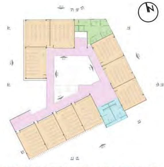
Gráfico 85. Plana de 2do Nivel, todas las aulas están comunicadas por una circulación exterior cubierta. Imagen de Plataforma de Arquitectura, 2010.
