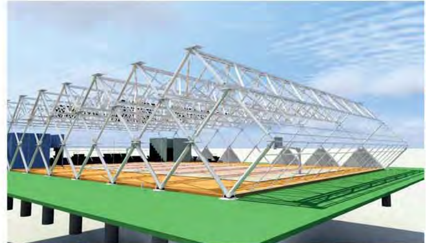
Gráfico 148. El gimnasio multiuso es proyectado a base de nodos que articulan la estructura.
