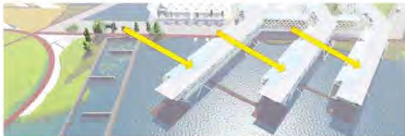
Gráfico 185. Todos los cuerpos de la UNECE cuentan con iluminación natural por medio de una envolvente en la fachada Sur.
