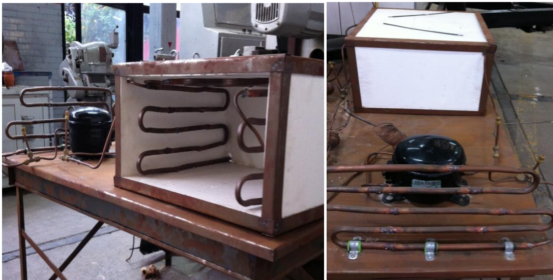
Figura 26. Sistema de refrigeración armado
