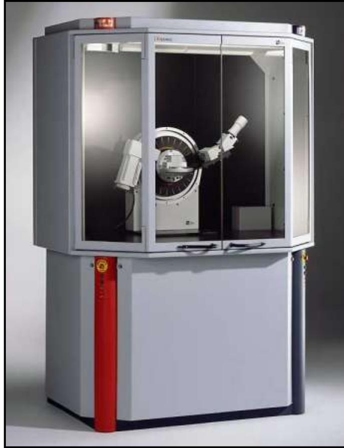
Figura 2.5.1. Difractómetro de rayos X Bruker D8 ADVANCE
