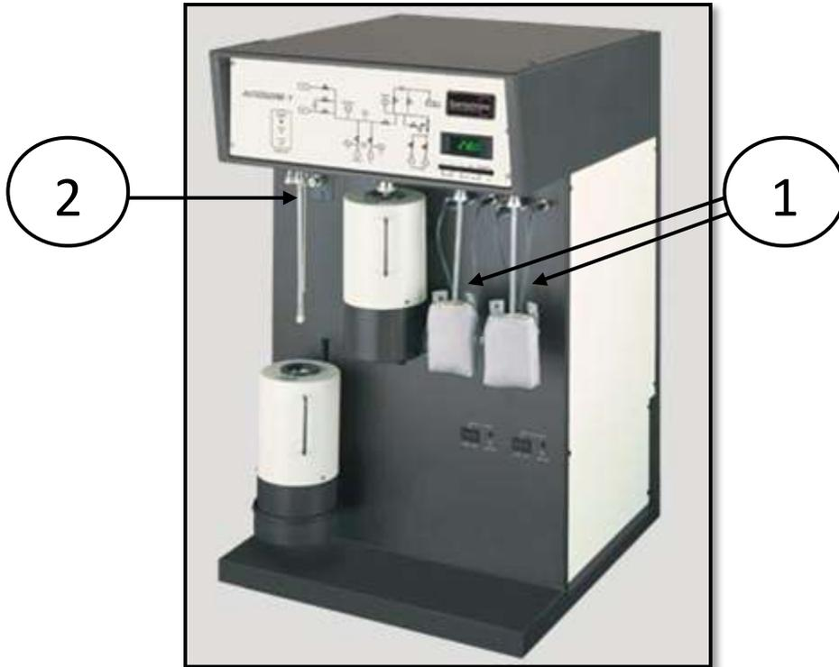
Figura 2.7.1. Analizador de área superficial Autosorb 1 de Quantachrome Instruments
