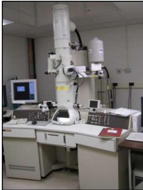
Figura 2.6.1. Microscopio electrónico de transmisión JEOL JEM-2010F
