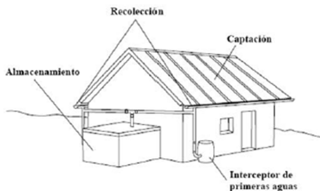
Figura 12. Fuente: Guía de Diseño para Captación de Agua de Lluvia. Sistema típico de captación de agua lluvia en techos CEPIS, 2004. Guía de Diseño para Captación de Agua de Lluvia. CEPIS, 2004. 21
