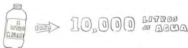
Figura 42. Dosificación de cloro
