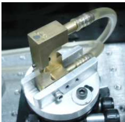
Figura 2.3: Montura en donde se encuentra el cristal de Ti : Al_2O_3
