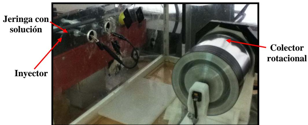
Figura 1.5. Equipo de electrohilado del Instituto de Investigaciones en Materiales (IIM-UNAM) usado para obtener nanofibras orientadas por medio de un colector rotatorio.
