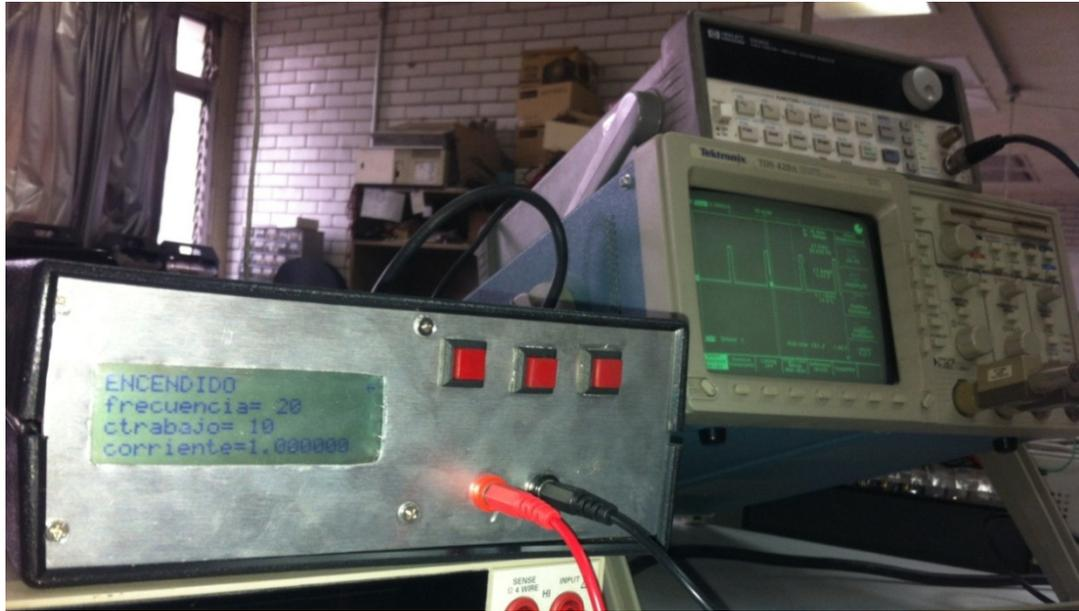
Figura IV.1 Prueba del Bioestimador con el osciloscopio
