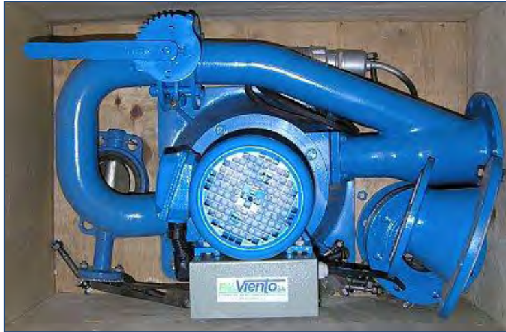
Figura IV-6.-Turbina Turgo de 110 KW. Fuente: Pro Viento.ec
