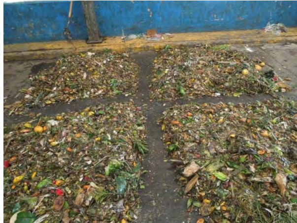
Figura 21. Método del cuarteo para obtener una muestra de la fracción orgánica que llega a la estación de transferencia de Coyoacán.
