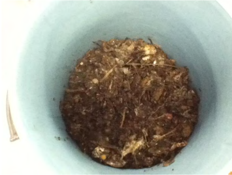
Figura 25. Residuos después de la primera trituración.
