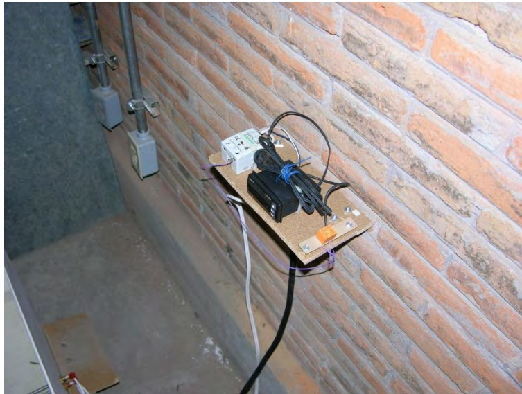
Figura 33. Controlador conectado a las resistencias y que regula la temperatura del baño María.
