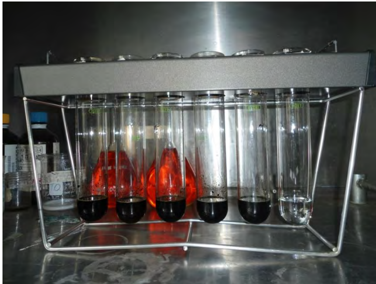
Figura 28. Determinación de nitrógeno total por el método Kjeldahl.
