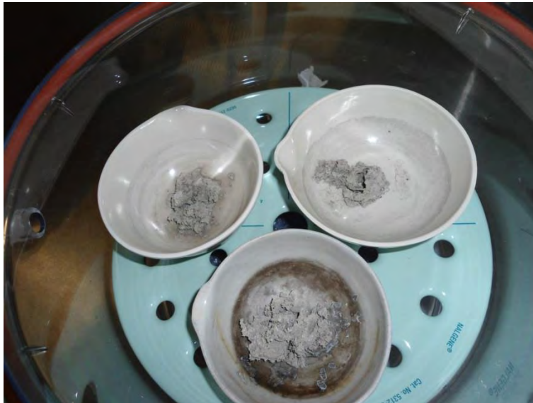
Figura 31. Determinación de sólidos volátiles.
