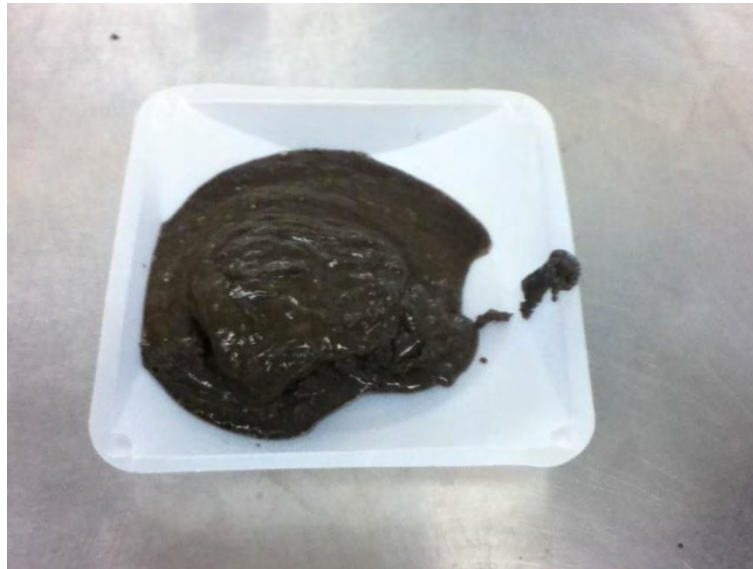
Figura 27. Residuos después de la trituración con el molino de semillas.
