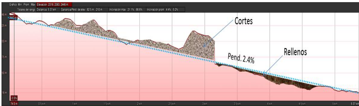
Figura # 4.23. Perfil del trazo por la cañada del Ferrocarril Central a Acámbaro (Línea N).
