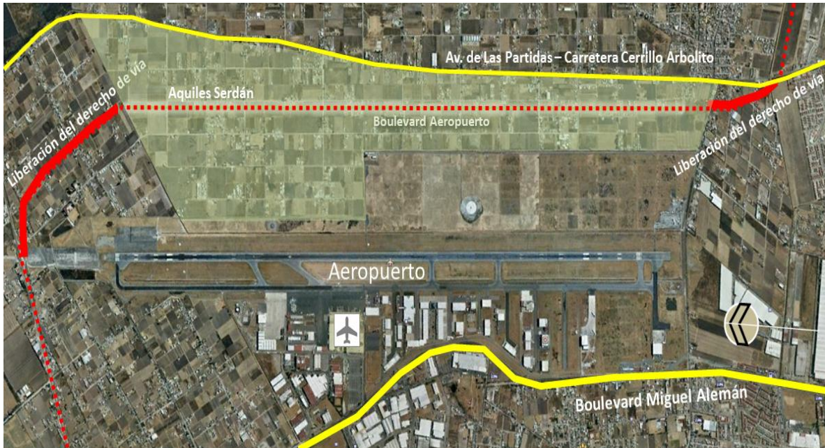
Figura # 4.12. Propuesta de trazo y zonas necesarias para liberación del derecho de vía en el Boulevard Aeropuerto.
