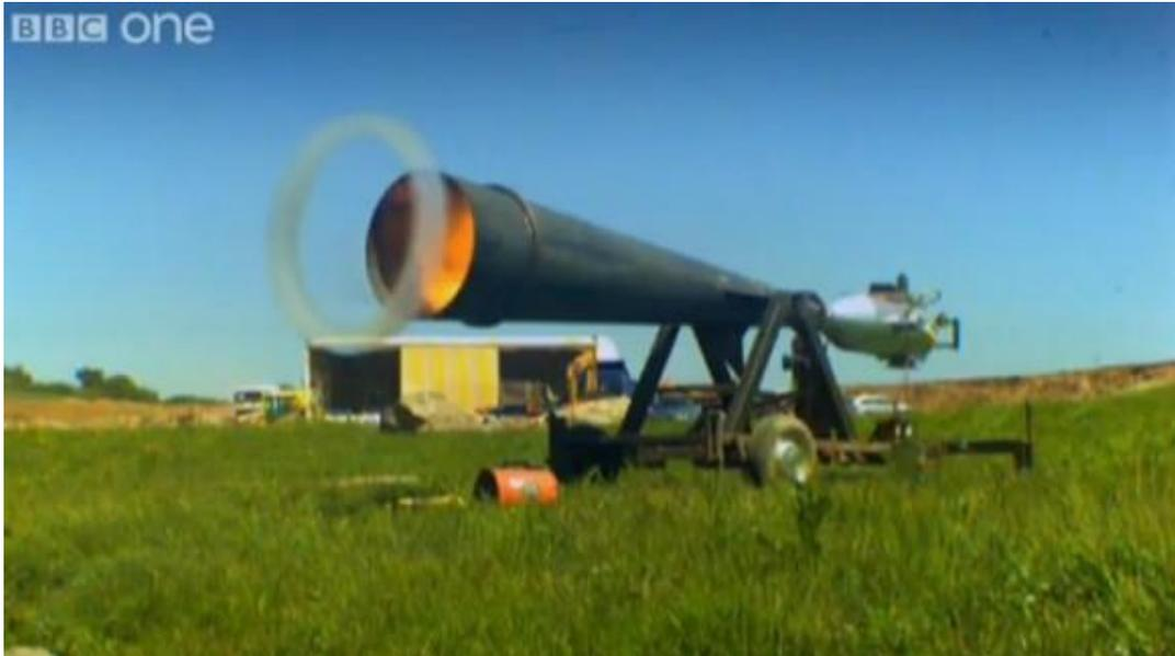
Dispositivo experimental para generar vórtices anulares<sup>6</sup>
