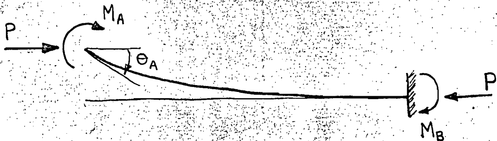
Fig. B.2 Columna en cantilever sin fuerza cortante
