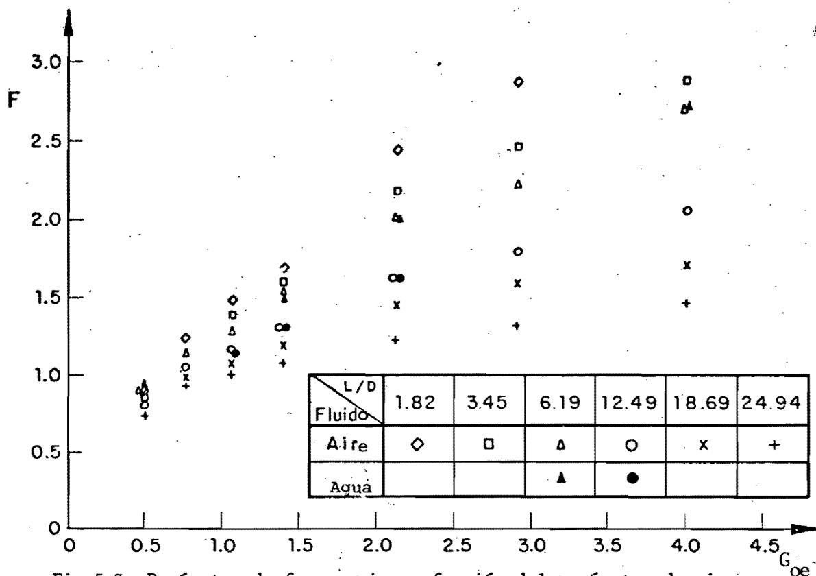
Fig 5.3: Parámetro de frecuencia en función del parámetro de giro a la entrada del tubo. (Puntos experimentales).
