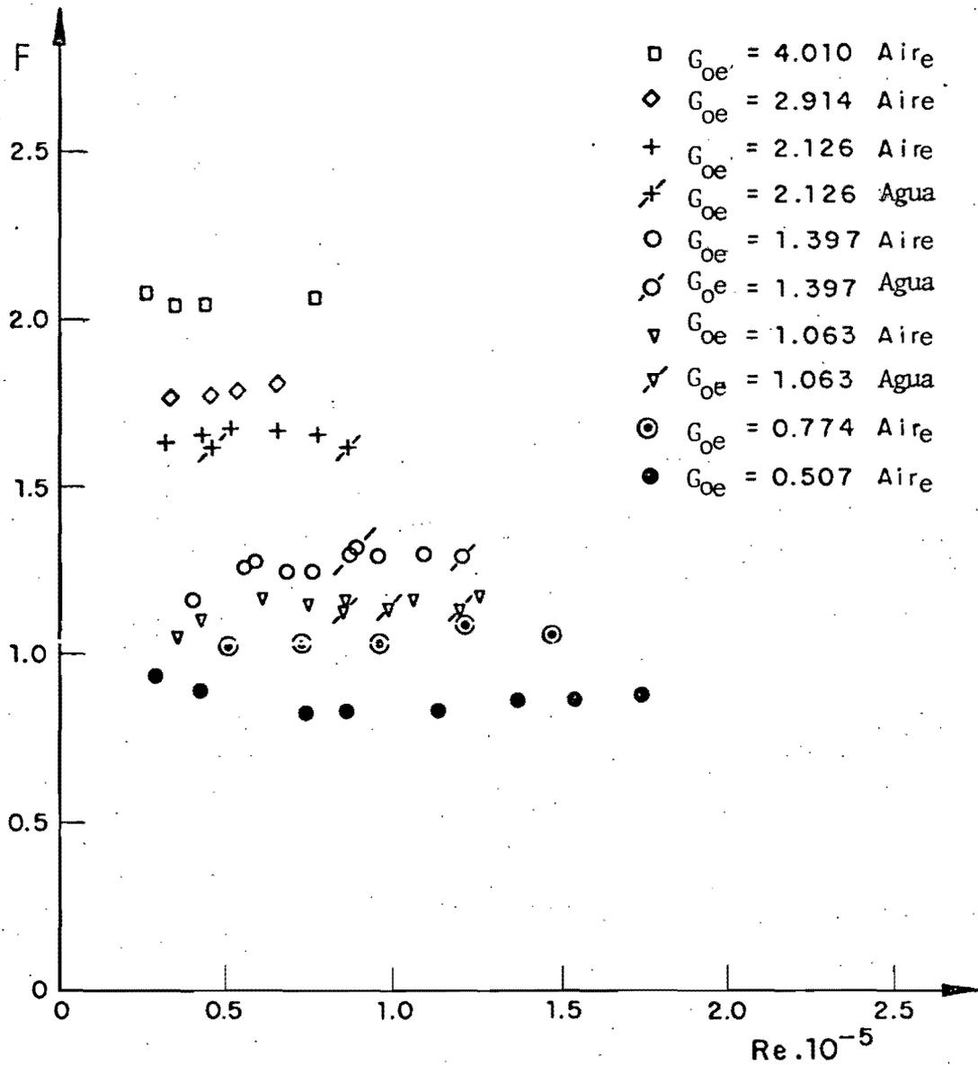
Fig. 5.2 Parámetro de frecuencia en función del número de Reynolds para tubo cilíndrico.  $L/D = 12.49$ . (Experiencias con aire y con agua).
