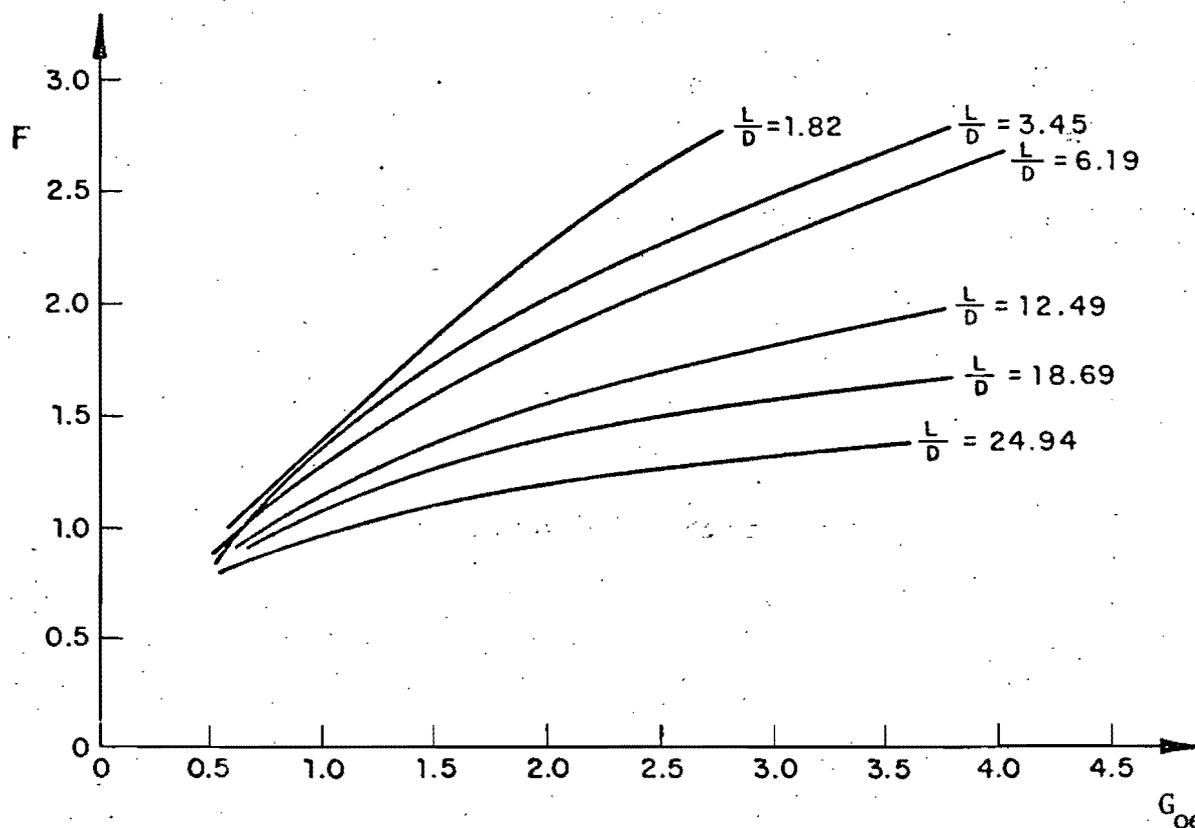
Fig. 5.4 Parámetro de frecuencia en función del parámetro de giro a la entrada del tubo. (Curvas ajustadas por mínimos cuadrados).
