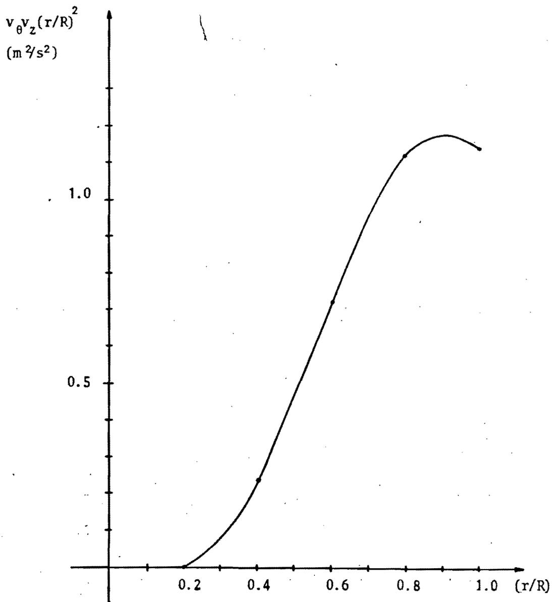
Fig. 4.11 Curva  $(r/R)^2 - v_\theta v_z (r/R)^2$ , para determinar el valor del parámetro de giro.
