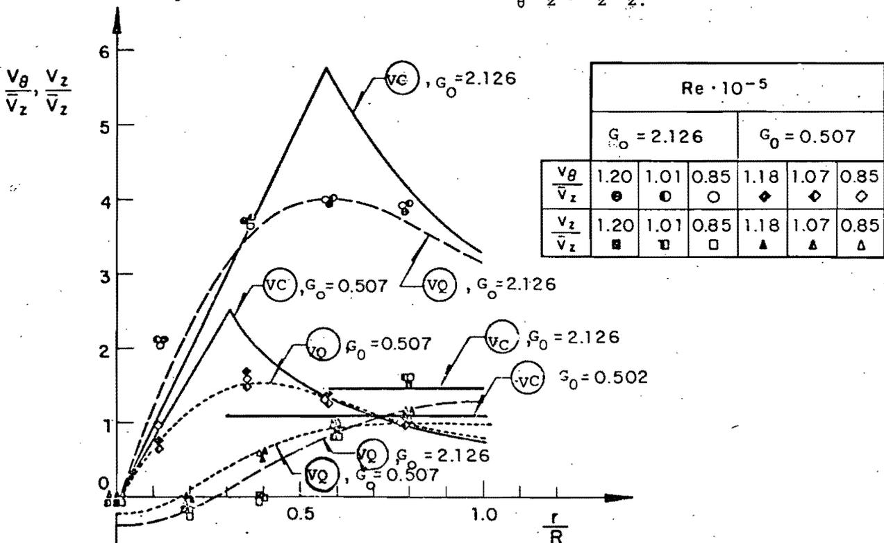
Fig. 4.6.b Distribución radial de  $v_\theta/\bar{v}_z$  y  $v_z/\bar{v}_z$ . (L/D = 12.49)
