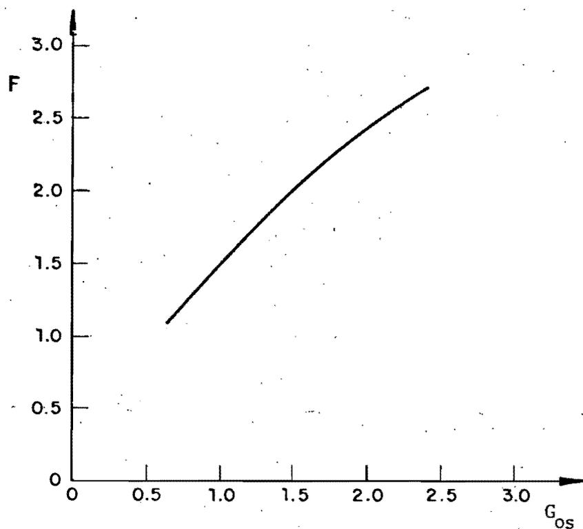
Fig. 5.8 Parámetro de frecuencia en función del parámetro de giro a la salida del tubo.
