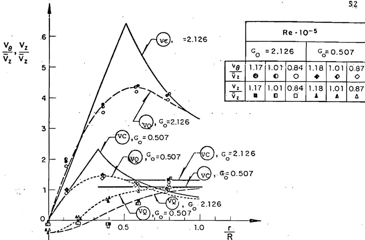
Fig. 4.6a Distribución radial de  $v_\theta/\bar{v}_z$  y  $v_z/\bar{v}_z$ . (L/D = 6.19)
