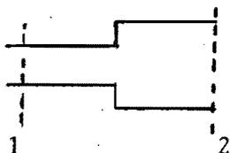
Figura 2.3 Cambio de sección
