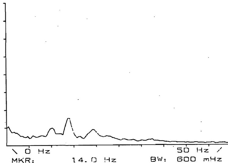
Fig. 5.1b Espectro de módulos de la señal de presión correspondiente a la toma ubicada 190 mm aguas arriba del plano de salida del tubo recto.
