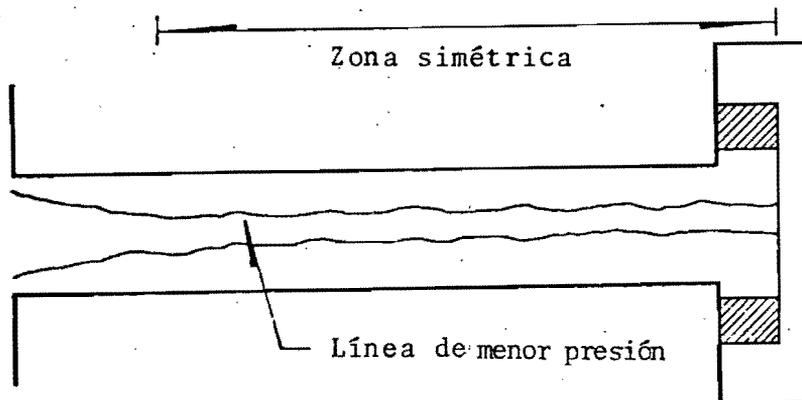
Fig. 4.5 Movimiento de la línea de mínima presión. Exp. 1/4 s.
