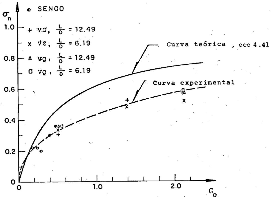
Fig. 4.8 Valores del radio del núcleo adimensionado ( $\sigma_n$ ) en función del parámetro de giro, empleando los modelos VC y VQ. Curva teórica  $G_0 - \sigma_n$ .
