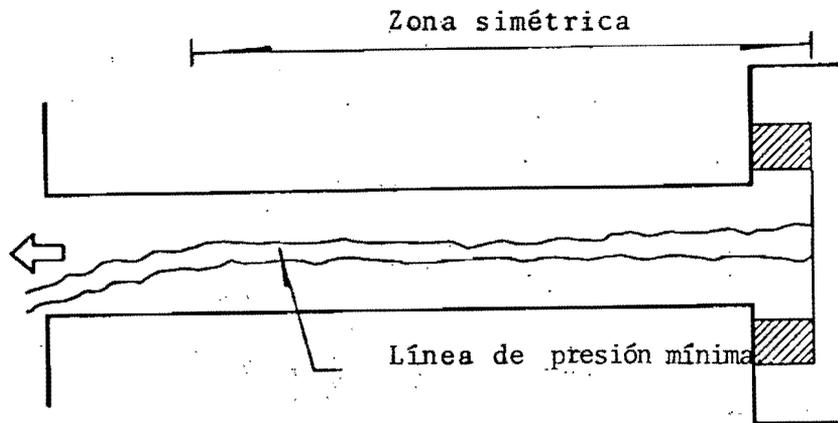
Fig.4.4 Localización de la línea de mínima presión. Exposición 1/2000 s
