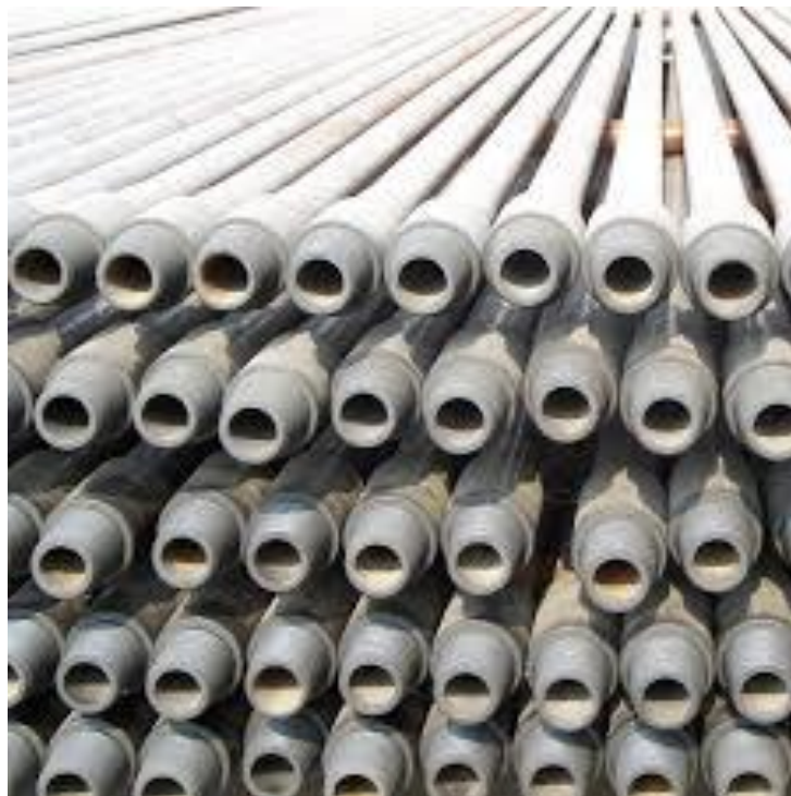
Tubería de perforación.
