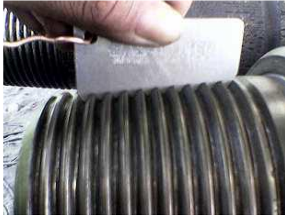
Medidor de perfil de rosca.
