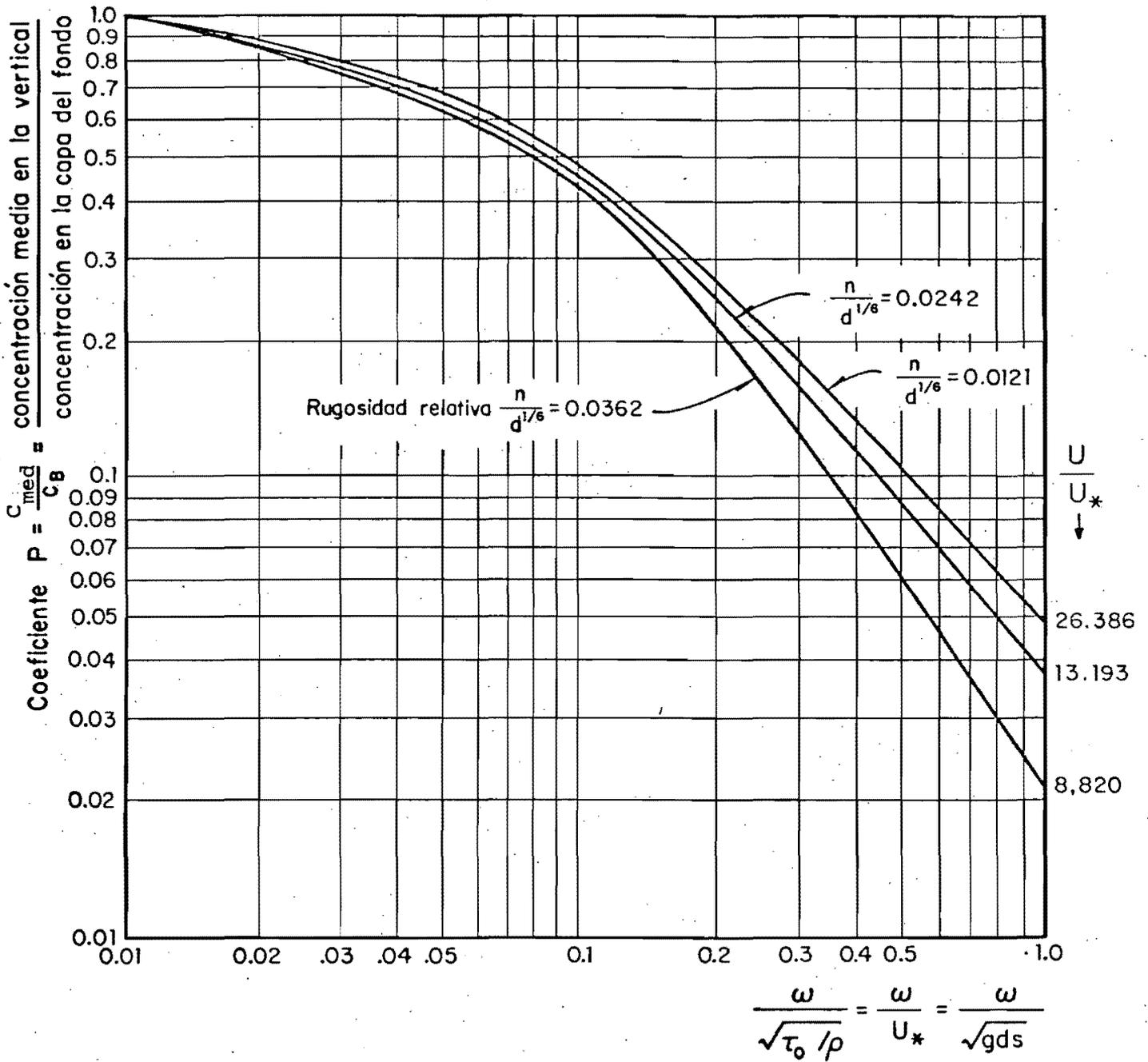
Fig 4.1.1 Valores del coeficiente P en función del parámetro  $\omega/U_*$ , para distintos valores de rugosidad relativa  $\frac{n}{d^{1/6}}$  (según Lane - Kalinske)
