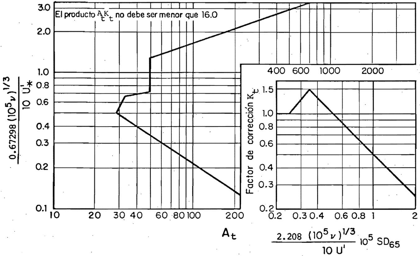
Fig. 4.7.1 Coeficiente  $A_t$  y factor de corrección  $K_t$  propuestos por Toffaletti
