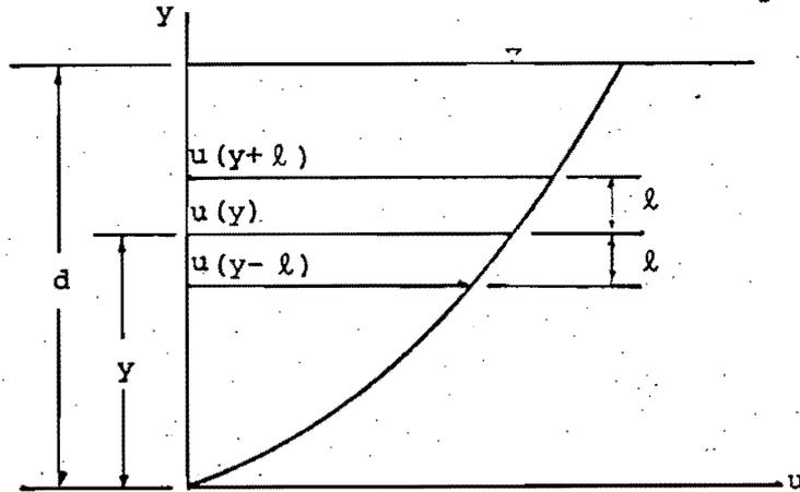
Fig. 2.1.3 DEFINICION DE LA LONGITUD DE MEZCLA SOBRE LA BASE DEL PERFIL DE VELOCIDADES.
