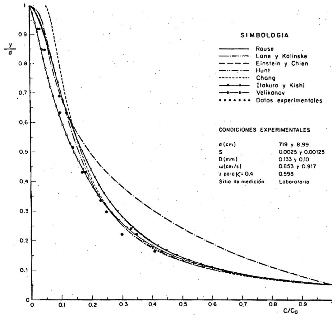
Fig 3.2.3 Distribución de concentraciones. Comparación de métodos para  $z = 0.598$
