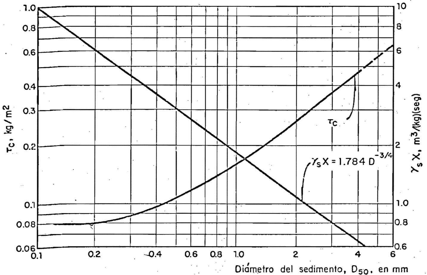
Fig. 2.2.5.2 COEFICIENTE CARACTERISTICO DE LOS SEDIMENTOS  $\chi$  Y ESFUERZO CORTANTE CRITICO  $\tau_c$  PARA SER UTILIZADOS EN LA ECUACION DE DUBOYS, SEGUN STRAUB (1935)
