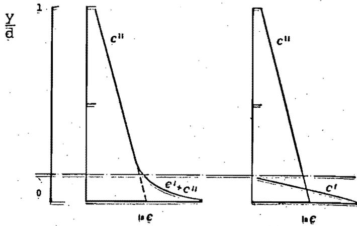
Fig. 2.4.1.1. DISTRIBUCION DE CONCENTRACIONES DE ACUERDO AL MODELO DE DOS CAPAS (SEGUN SHULYAK Y AN TSYFEROV)
