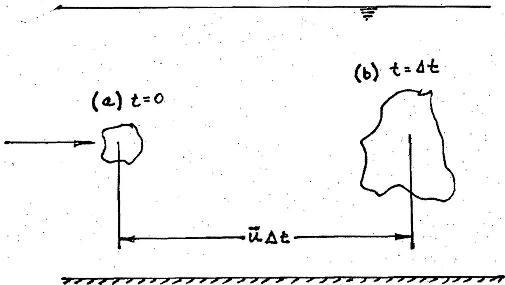
Fig. 2.1 DIFUSION EN FLUJO TURBULENTO
