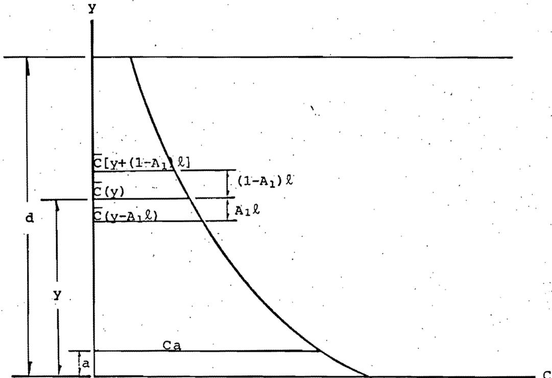
Fig. 2.2.2.1 PULSACIONES DE LA CONCENTRACION DE SEDIMENTOS DEFINIDA EN TERMINOS DE LA LONGITUD DE MEZCLA, SEGUN EINSTEIN Y CHIEN.
