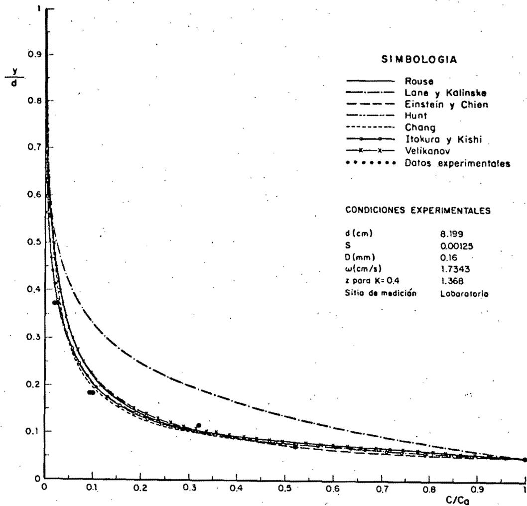
Fig 3.2.1 Distribución de concentraciones. Comparación de métodos para  $z = 1.368$
