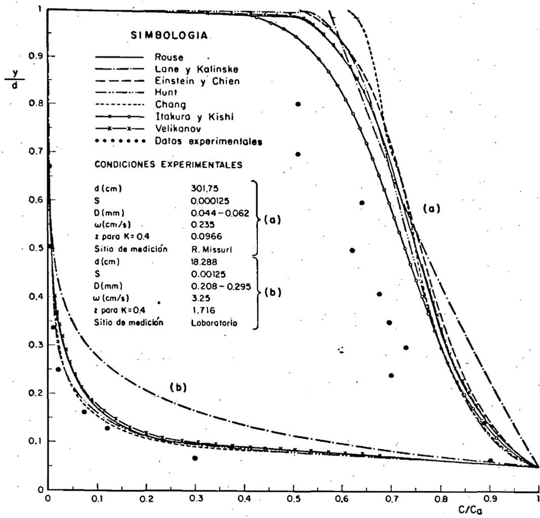
Fig 3.2.5 Distribución de concentraciones. Comparación de métodos para (a)  $z=0.096$
