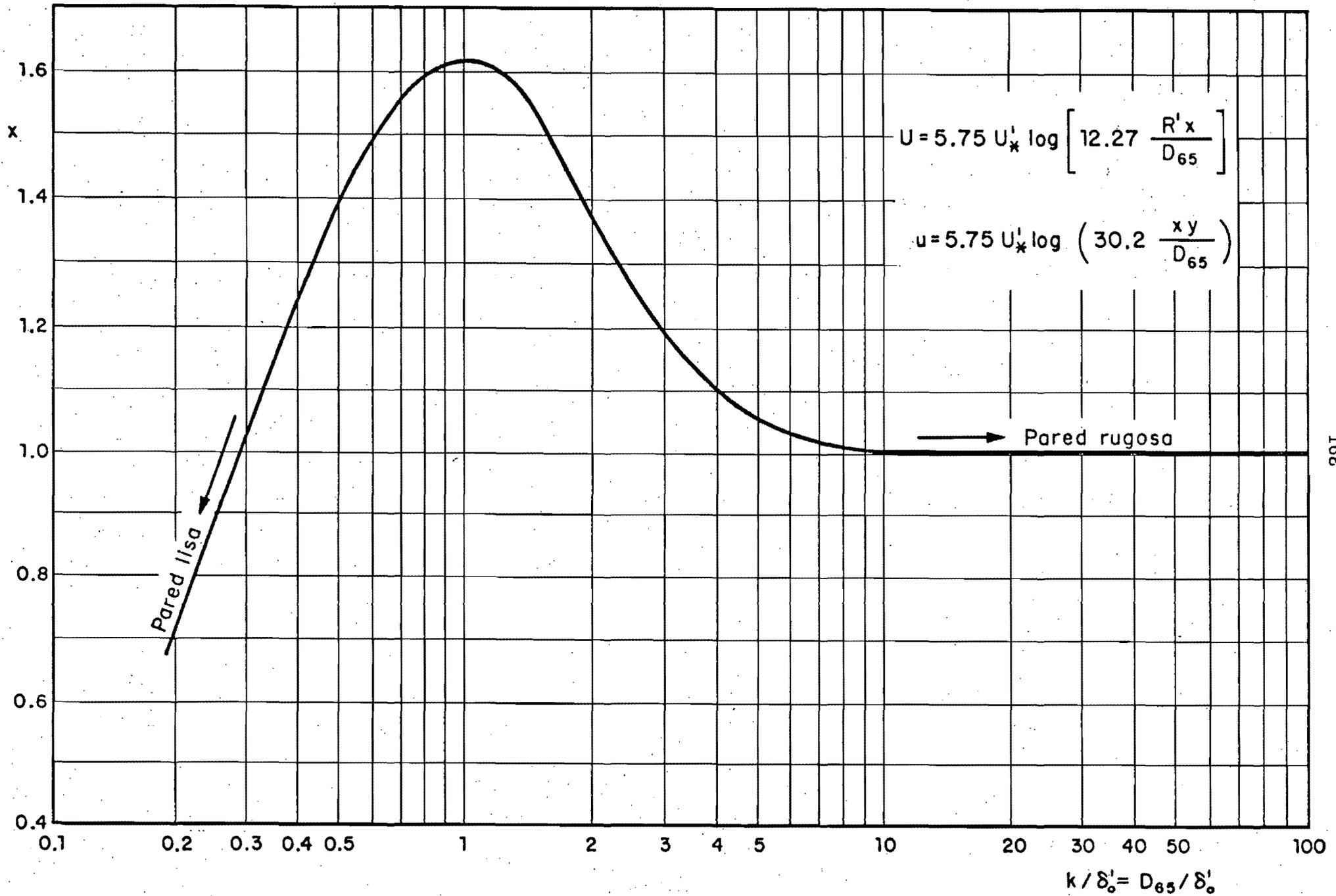
Fig 4.2.1 Corrección  $x$  en la fórmula de fricción logarítmica en función de  $k / \delta_0'$ . Método de Einstein
