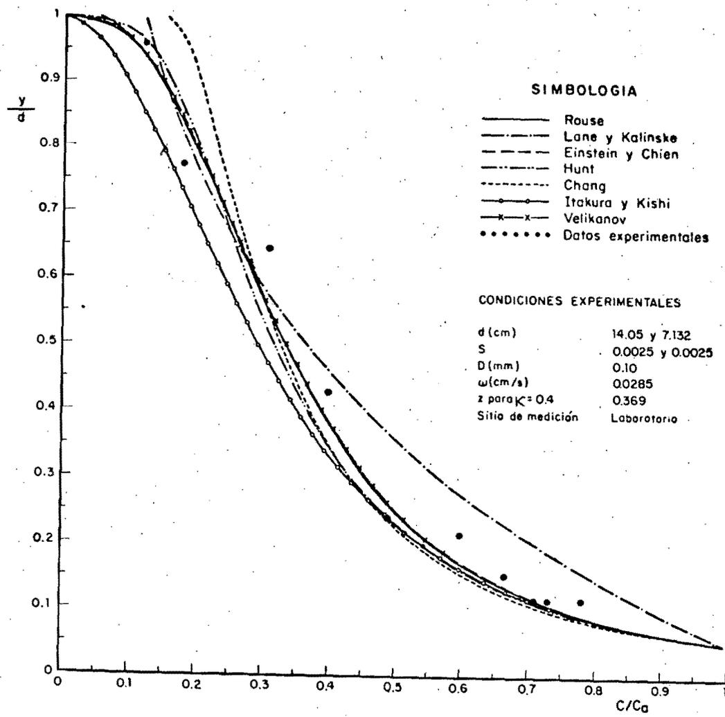
Fig 3.24 Distribución de concentraciones. Comparación de métodos para  $z = 0.369$
