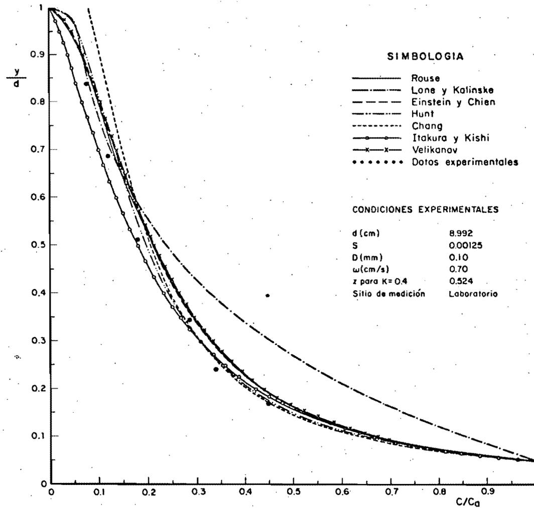
Fig 3.2.6 Distribución de concentraciones. Comparación de métodos para  $z = 0.524$
