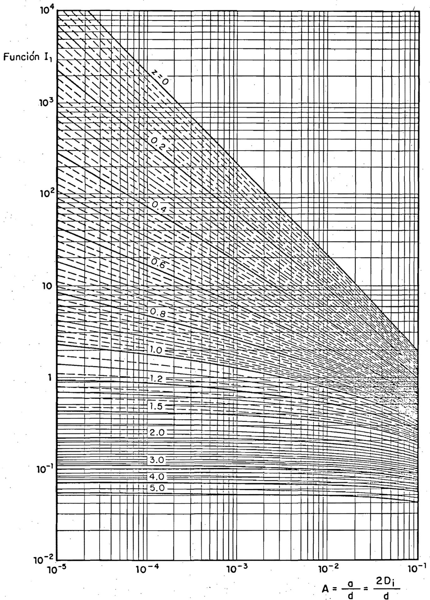
Fig 4.2.3 Función  $I_1$  en términos del parámetro  $A$  para distintos valores de  $Z$ , según Einstein (1950)
