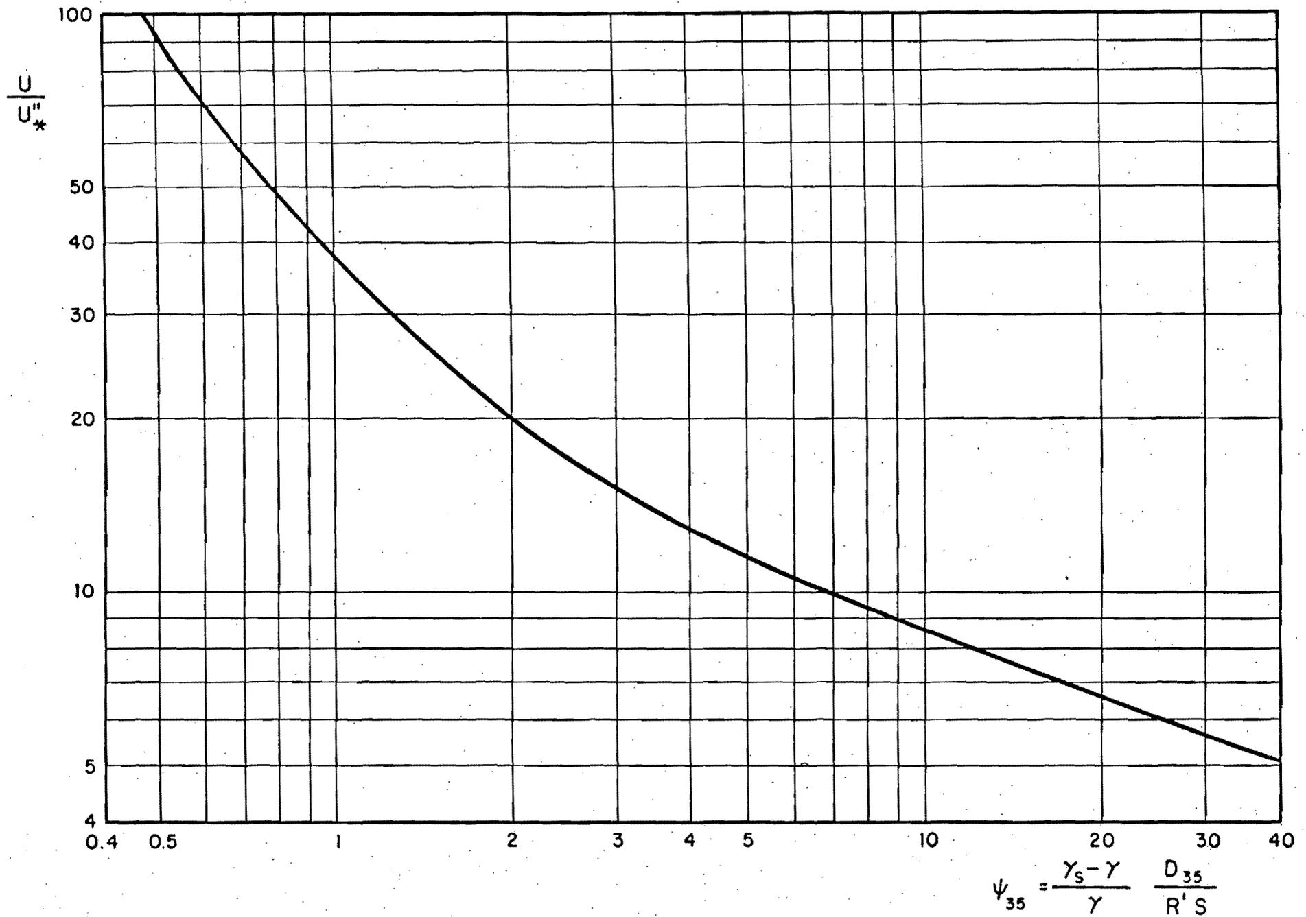
Fig.4.2.2 Velocidad  $U_*''$ , debida a las ondulaciones en el fondo. Método de Einstein
