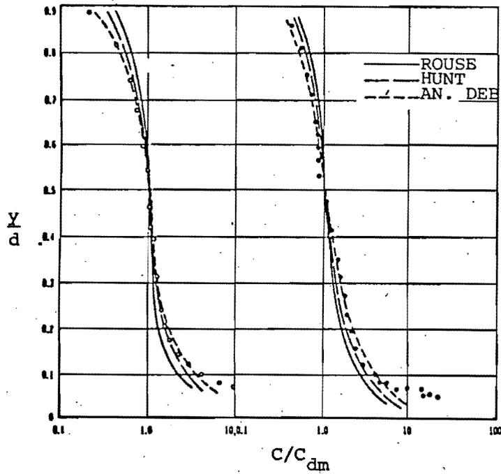
Fig. 3.2.8 COMPARACION DE LOS METODOS DE ROUSE, HUNT Y ANTSY FEROV Y DEBOL'SKIY, CON LOS DATOS EXPERIMENTALES DE TAGGART.
