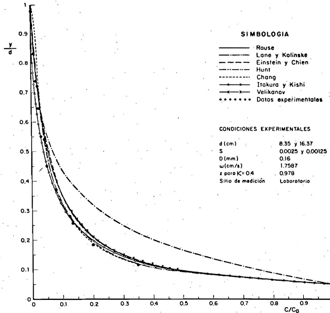
Fig 3.2.2 Distribución de concentraciones. Comparación de métodos para  $z = 0.978$
