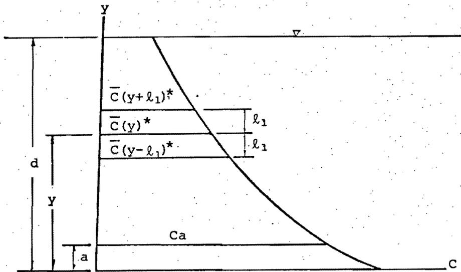
Fig. 2.1.2 PULSACIONES DE LA CONCENTRACION DE SEDIMENTOS DE FINIDA EN TERMINOS DE LA LONGITUD DE MEZCLA
