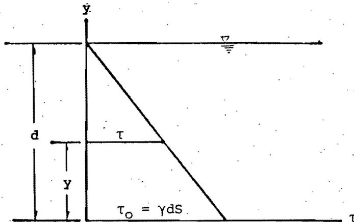
Fig. 2.1.4 DISTRIBUCION DEL ESFUERZO CORTANTE
