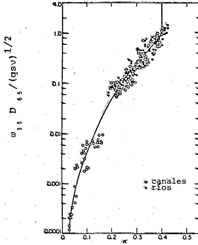
Fig 4.8.1 VARIACION DEL COEFICIENTE  $\kappa$  EN TERMINOS DE  $\omega_{3.5} D_{6.5} / (qsv)^{1/2}$
