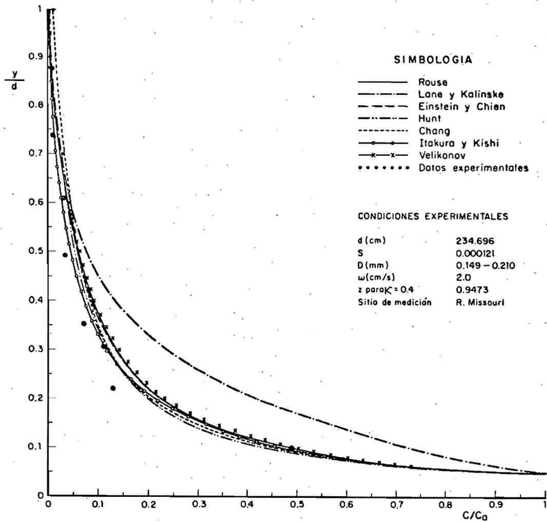
Fig 3.2.7 Distribución de concentraciones. Comparación de métodos para  $z = 0.9473$
