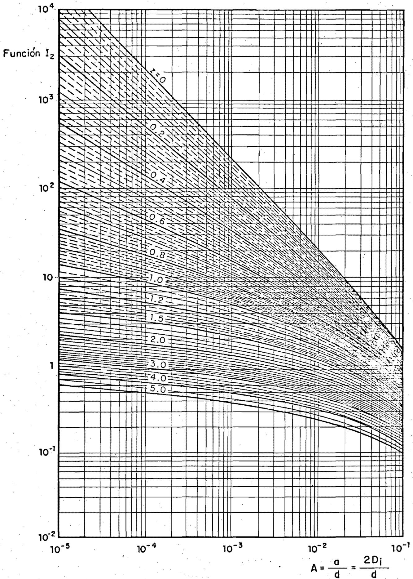
Fig. 4.2.4 Función  $I_2$  en términos del parámetro  $A$  para distintos valores de  $Z$ , según Einstein (1950)
