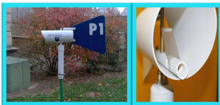
Figura 29. Trampa Pasiva de Esporas. Penn State/UNAM (Scott Isard, Penn state)
